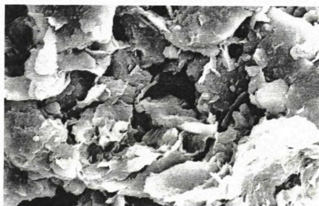
Obr. 10 Mikrograf zeminy s voštinovým typom mikroštruktúry.
